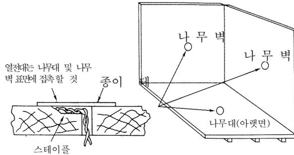
그림 C7. 나무대 및 나무벽 표면 온도 측정 장치
