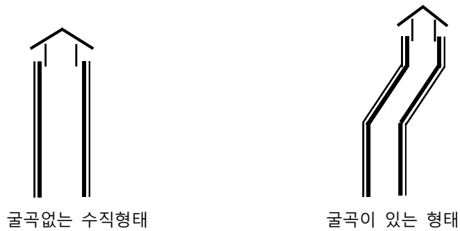
그림 2.7.1.4.3③ 복합공동배기구 설치 예
