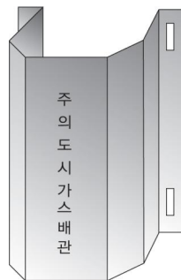
그림 2.5.4.3.3① “ㄷ” 형태로 가공한 방호철판에 의한 방호구조물
