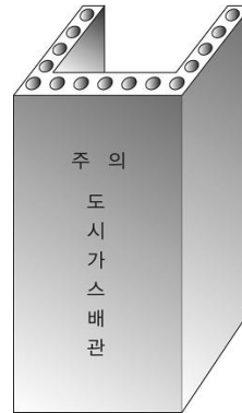
그림 2.5.4.3.3③ “ㄷ” 형태의 철근콘크리트재 방호구조물
