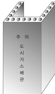
그림 2.5.4.3.3③ “C” 형태의 철근콘크리트재 방호구조물
