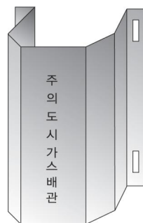
그림 2.5.4.3.3① “ㄷ” 형태로 가공한 방호철판에 의한 방호구조물
