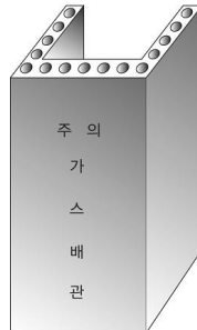
그림 2.5.7.6.11(2)③ “ㄴ” 형태의 철근콘크리트재 방호구조물에 의한 방호조치
