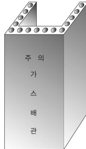
그림 2.5.7.6.9(2)③ “ㄴ” 형태의 철근콘크리트제 방호구조물에 의한 방호조치
