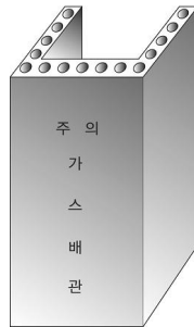
그림 2.5.7.6.9(2)③ “ㄷ” 형태의 철근콘크리트제 방호구조물에 의한 방호조치
