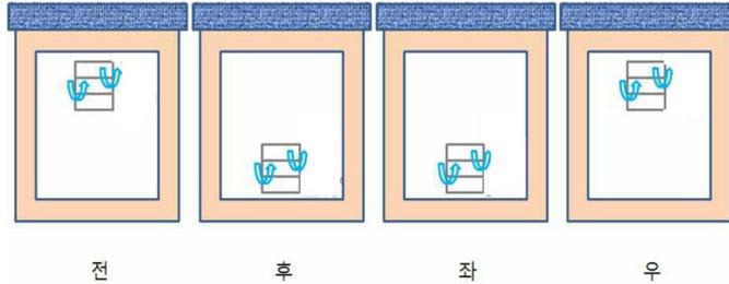
그림 2.7.4.1.1 정압기실 환기구의 설치 예
