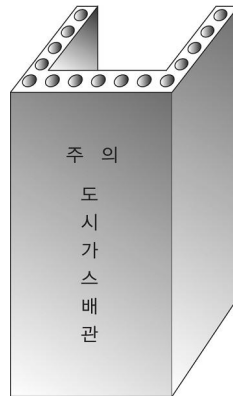
그림 2.5.8.3.1(4)③ “ㄷ” 형태의 철근콘크리트재 방호구조물
