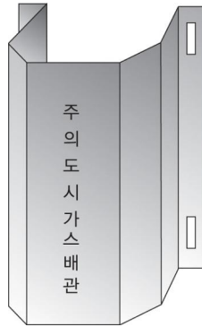
그림 2.5.8.3.1(4)① “ㄷ” 형태로 가공한 방호철판에 의한 방호구조물
