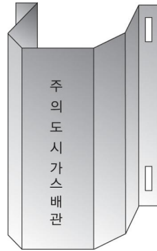
그림 2.5.8.3.1(4)① “ㄷ” 형태로 가공한 방호철판에 의한 방호구조물
