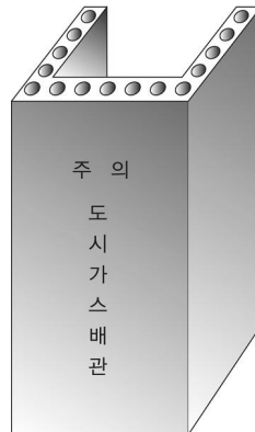
그림 2.5.8.3.1(4)③ “ㄷ” 형태의 철근콘크리트재 방호구조물
