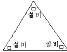
설비군 바닥면 둘레 = 실선부분 길이 그림 2.7.2.4② 여러 개의 설비를 한 개의 군으로 형성
