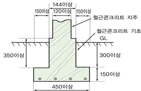
그림 2.8.2.1 철근콘크리트 방호벽의 설치 예
