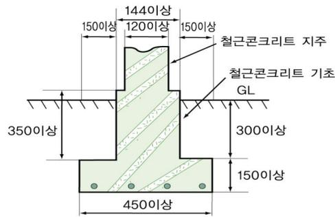
그림 2.7.2.1.2 철근콘크리트제 방호벽 설치 예
