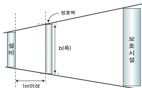
그림 2.7.2.1.2② 방호벽 설치예(평면도)
