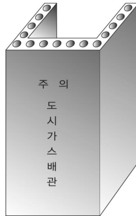
그림 2.5.7.3.3③ 철근콘크리트 방호조치
