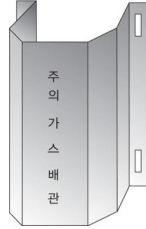
그림 2.5.7.3.2(1) 방호철판을 사용한 방호구조물 예시
