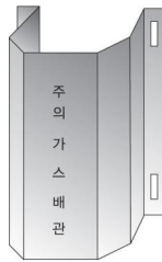
그림 2.5.7.3.2(1) 방호철판을 사용한 방호구조물 예시
