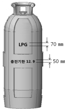
그림 3.12.2.3 액화석유가스용 복합재료용기 문자 및 그림의 크기 <개정 14.11.17>
