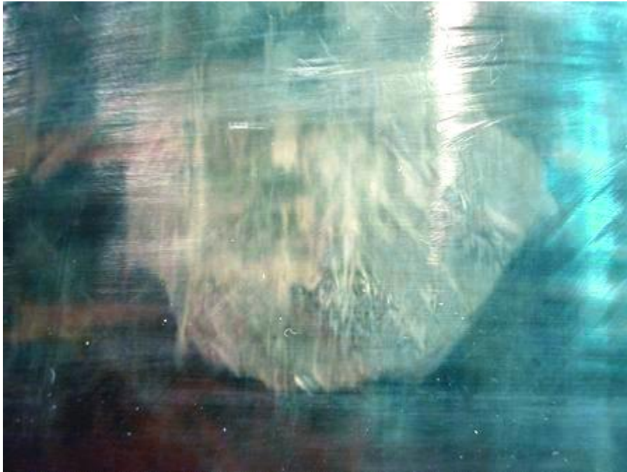
그림 1 접합부의 바깥부분에 위치, 지름 약 25mm의 층상박리 - 허용되는 결함
