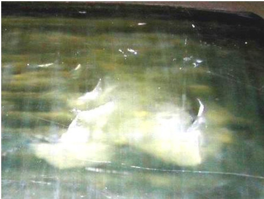
그림 5 표면결함과 연결된 층상박리 - 허용되지 않는 손상
