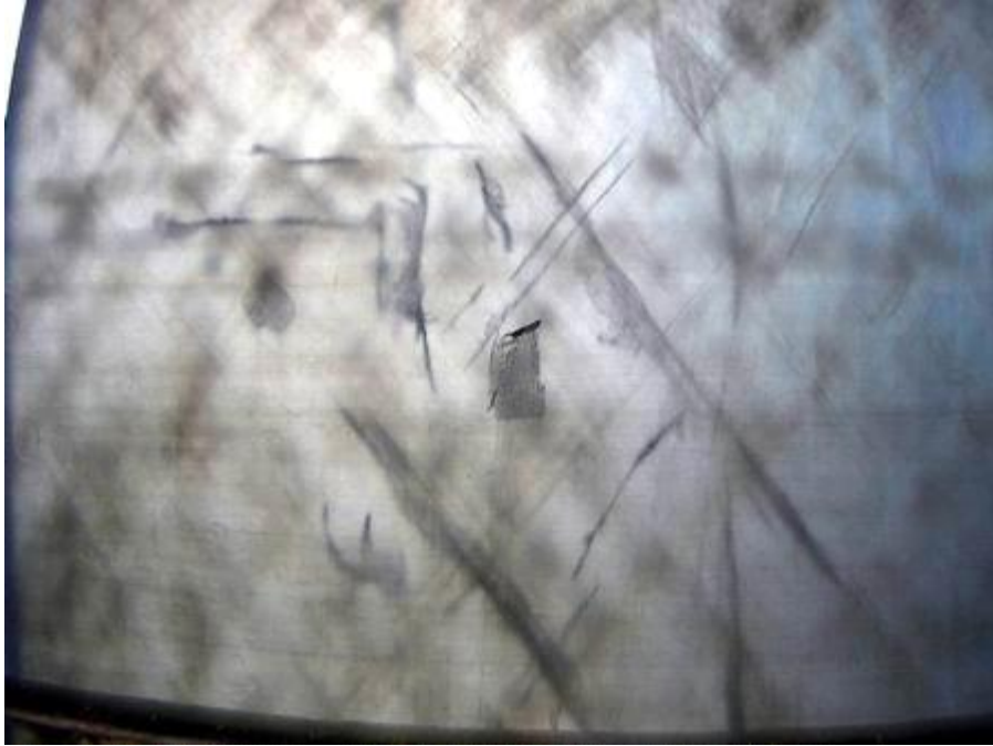
그림 4 표면 아래 2개의 복합재료에 있는 균열-인접한 부분에 이런 유형의 결함이 손바닥크기를 초과해서는 안된다.
