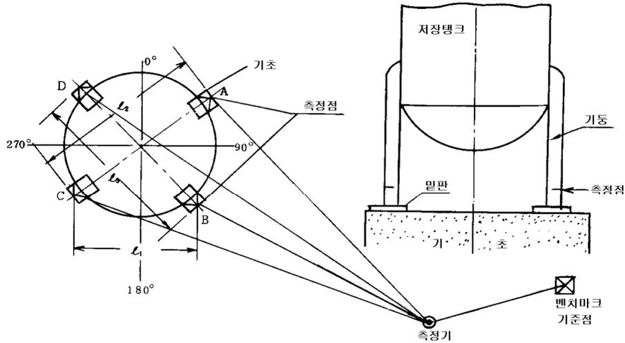
그림 2-1b 수직원통형 저장탱크의 부등침하율 측정방법
