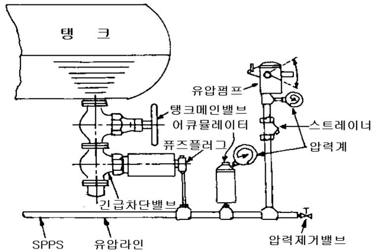
그림 6-1 긴급차단장치의 설치(예)
