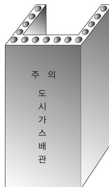
그림 2.5.4.3.3③ “ㄷ” 형태의 철근콘크리트재 방호구조물
