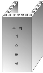
그림 2.5.7.6.11(2)③ “ㄷ” 형태의 철근콘크리트재 방호구조물에 의한 방호조치
