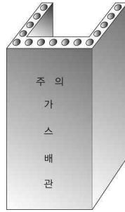
그림 2.5.7.6.11(2)③ “ㄷ” 형태의 철근콘크리트재 방호구조물에 의한 방호조치
