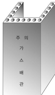
그림 2.5.7.6.9(2)③ “C” 형태의 철근콘크리트제 방호구조물에 의한 방호조치
