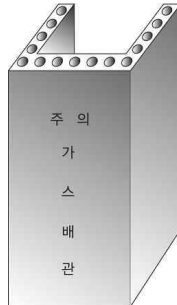
그림 2.5.7.6.9(2)③ “ㄷ” 형태의 철근콘크리트제 방호구조물에 의한 방호조치
