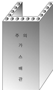
그림 2.5.7.6.9(2)③ “ㄷ” 형태의 철근콘크리트제 방호구조물에 의한 방호조치
