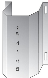
그림 2.5.7.3.2(1) 방호철판을 사용한 방호구조물 예시
