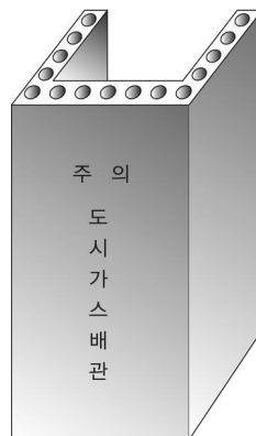
그림 2.5.8.3.1(4)③ “ㄷ” 형태의 철근콘크리트재 방호구조물
