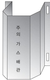
그림 2.5.8.3.2(1) 방호철판을 사용한 방호구조물 예시
