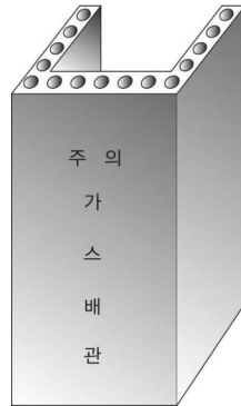
그림 2.5.8.3.2(3) 철근콘크리트재 방호구조물 예시
