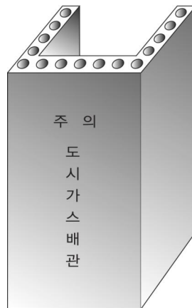
그림 2.5.7.3.3③ 철근콘크리트 방호조치
