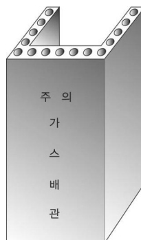
그림 2.5.7.3.2(3) 철근콘크리트재 방호구조물 예시
