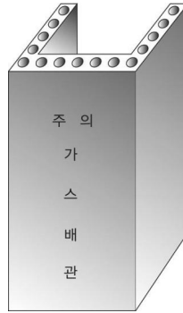
그림 2.5.7.3.2(3) 철근콘크리트재 방호구조물 예시
