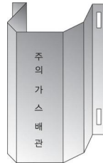
그림 2.5.7.3.2(1) 방호철판을 사용한 방호구조물 예시
