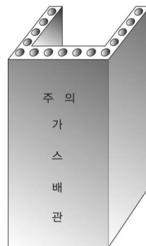
그림 2.5.7.3.2(3) 철근콘크리트재 방호구조물 예시
