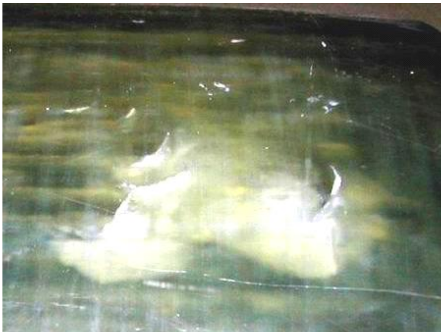
그림 5 표면결함과 연결된 층상박리 - 허용되지 않는 손상
