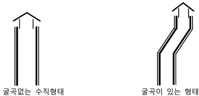
그림 2.7.1.3.2④ 복합공동배기구 설치 예
