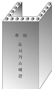
그림 2.5.4.3.3③ “ㄷ” 형태의 철근콘크리트재 방호구조물
