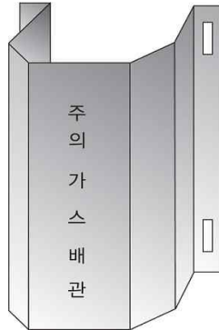
그림 2.5.7.6.11(2)① “ㄷ” 형태로 가공한 철판제 방호구조물에 의한 방호조치
