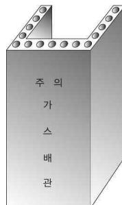
그림 2.5.7.6.11(2)③ “T” 형태의 철근콘크리트재 방호구조물에 의한 방호조치
