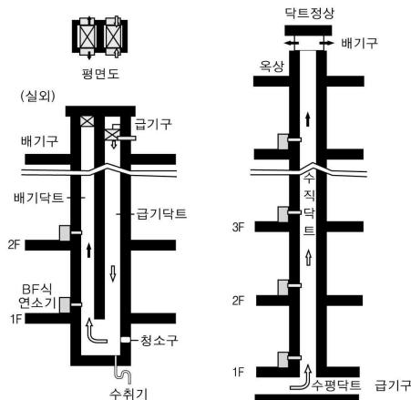
그림 B3.2.3.3.6① SE 및 U닥트의 설치 예시
