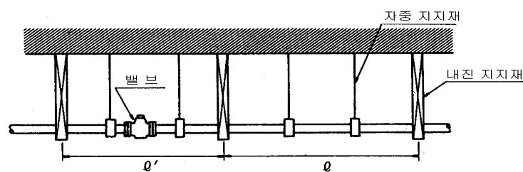
그림 E9.3 밸브 설치 시 지지의 예
