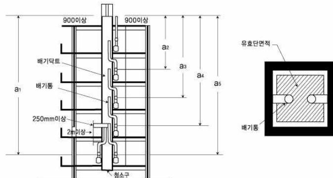
그림 B2.5.1.18 공동배기구의 설치 예시
