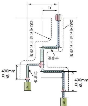
그림 2.7.1.3.2 복합 배기통의 설치 예
