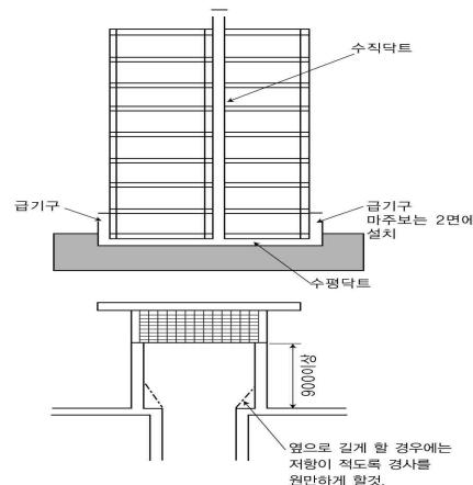
그림 B3.2.3.3.6③ SE 닉트의 설치 예시
