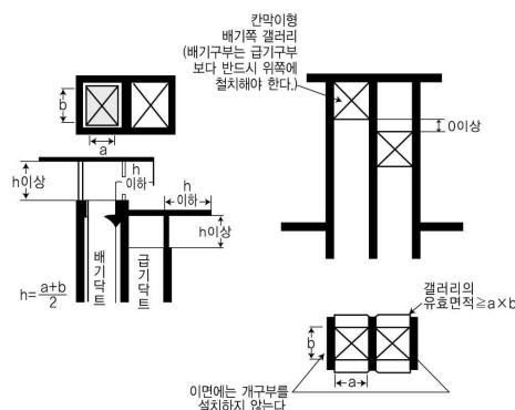
그림 B3.2.3.3.6② U닥트의 설치 예시
