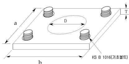
그림 2.3.3.6.3 강관제 보호대의 받침대 설치 방법
