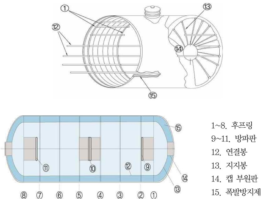
그림 2.3.3.5.2 폭발방지장치 설치의 보기 및 전체조립도
