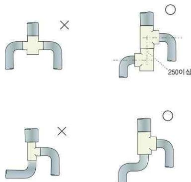
그림 2.7.1.3.1(3) 복합배기통 설치 예시
