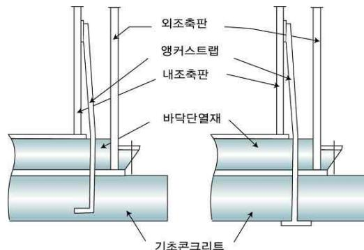
그림 2.2.3.7 평저원통형 저장탱크의 앵커스트립 설치방법
