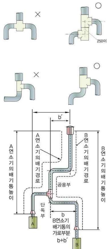
그림 B2.4.6 복합 배기통의 설치 예시
