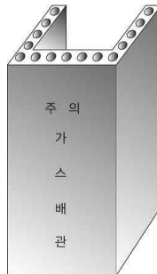
그림 2.5.7.6.9(2)③ “C” 형태의 철근콘크리트제 방호구조물에 의한 방호조치
