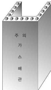
그림 2.5.7.6.9(2)③ “C” 형태의 철근콘크리트제 방호구조물에 의한 방호조치
