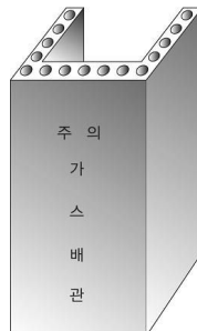
그림 2.5.7.6.9(2)③ “ㄷ” 형태의 철근콘크리트제 방호구조물에 의한 방호조치
