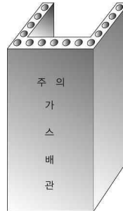
그림 2.5.7.6.9(2)③ “ㄷ” 형태의 철근콘크리트제 방호구조물에 의한 방호조치
