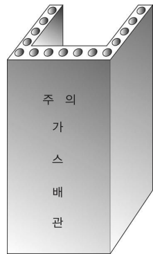
그림 2.5.8.3.2(3) 철근콘크리트재 방호구조물 예시
