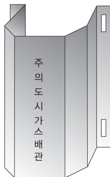
그림 2.5.8.3.1(4)① “ㄷ” 형태로 가공한 방호철판에 의한 방호구조물
