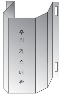
그림 2.5.8.3.2(1) 방호철판을 사용한 방호구조물 예시
