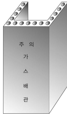
그림 2.5.8.3.2(3) 철근콘크리트재 방호구조물 예시
