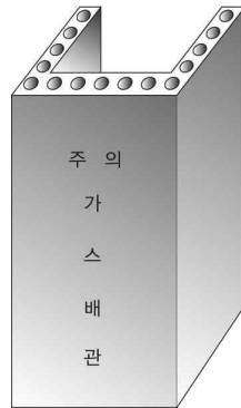
그림 2.5.8.3.2(3) 철근콘크리트재 방호구조물 예시
