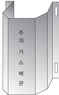
그림 2.5.8.3.2(1) 방호철판을 사용한 방호구조물 예시
