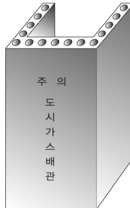
그림 2.5.7.3.3③ 철근콘크리트 방호조치
