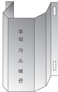
그림 2.5.7.3.2(1) 방호철판을 사용한 방호구조물 예시
