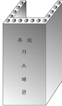
그림 2.5.7.3.2(3) 철근콘크리트재 방호구조물 예시
