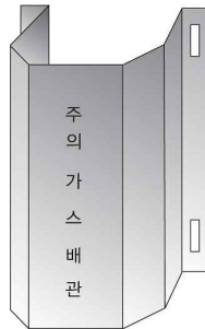
그림 2.5.7.3.2(1) 방호철판을 사용한 방호구조물 예시
