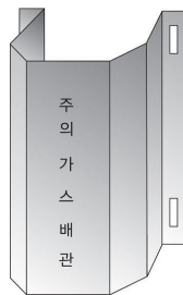
그림 2.5.7.3.2(1) 방호철판을 사용한 방호구조물 예시
