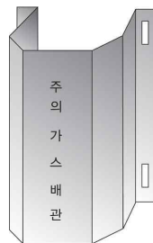
그림 2.5.7.3.2(1) 방호철판을 사용한 방호구조물 예시
