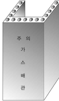
그림 2.5.7.3.2(3) 철근콘크리트재 방호구조물 예시
