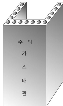
그림 2.5.7.3.2(3) 철근콘크리트제 방호구조물 예시
