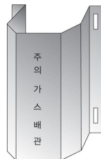
그림 2.5.7.3.2(1) 방호철판을 사용한 방호구조물 예시
